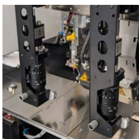
配备多个工艺相机以实现快速工艺开发和细节观测
